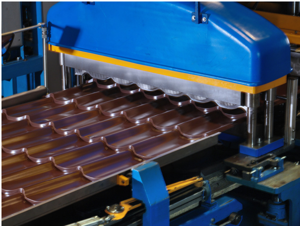
Abbildung 3: Kaltumformen von Dacheindeckungen
